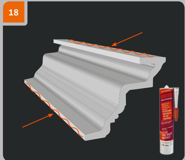
«Evroplast Multipurpose» Adhesive auf das gesamte nachfolgend zu montierende Bauteil auftragen (auf der zu befestigenden Fläche). Die Klebstoffschicht sollte 3-5 mm dick sein.
