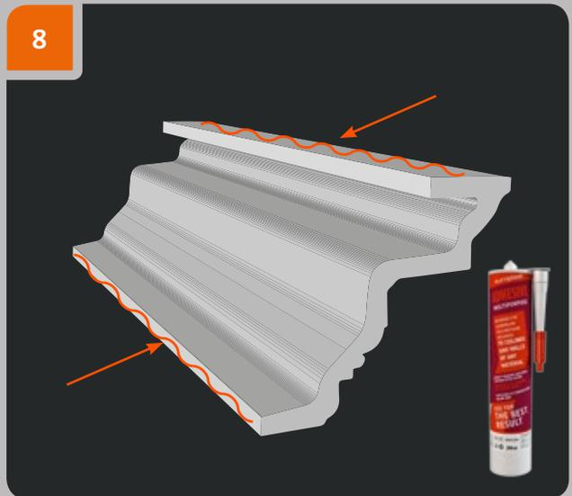
«Evroplast Multipurpose» Adhesive gleichmäßig auf das gesamte Teil auftragen. Die Klebstoffschicht sollte 3-5 mm dick sein.
