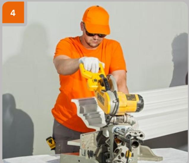
Mit einer Kappsäge, die auf den entsprechenden Winkel eingestellt ist, einen Schnitt in das Teil machen.
